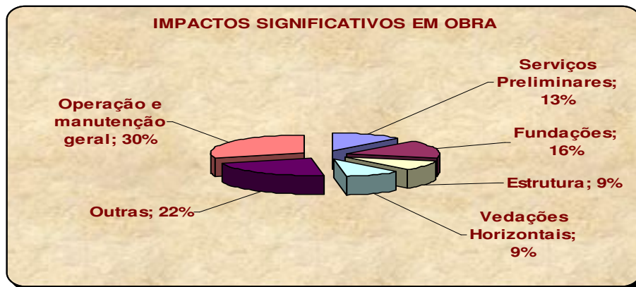
FIGURA 2 - Distribuição percentual de impactos ambientais significativos entre as atividades de uma obra de edificação
