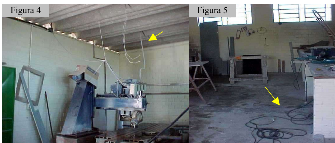
Figuras 4 e 5 - Instalações elétricas inadequadas e Cabos elétricos em local de passagem
