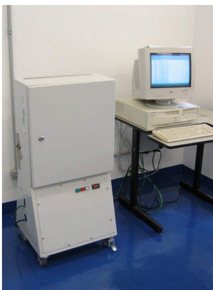
Figura 3 – Banco experimental de ensaios de relés
