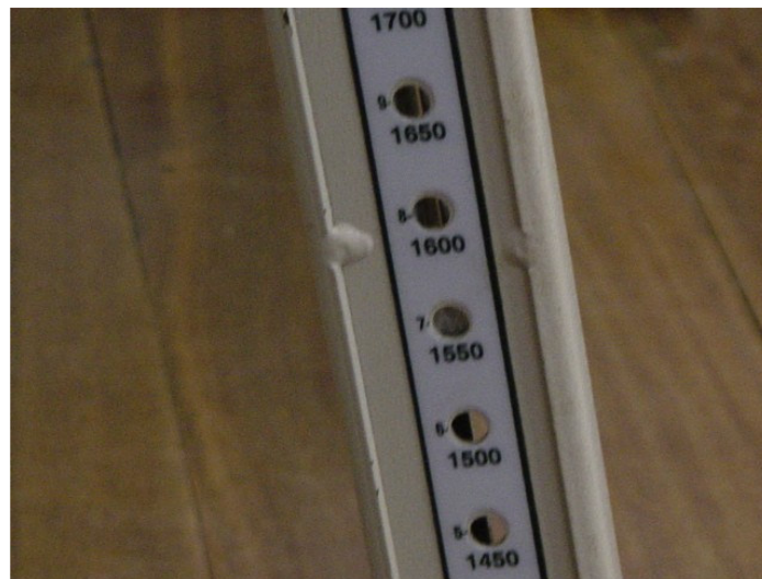
Figura 2 – Suporte da mesa da carteira com diferentes regulagens
