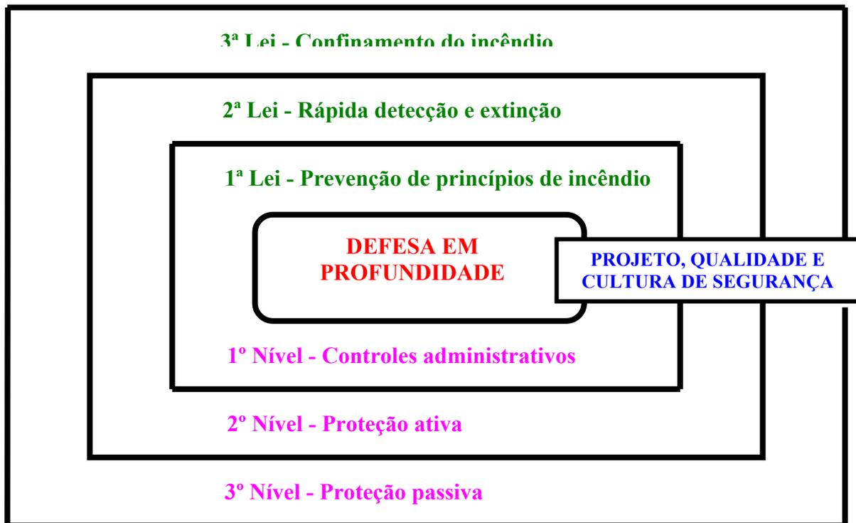
Figura 2 – Defesa em profundidade em proteção contra incêndio
