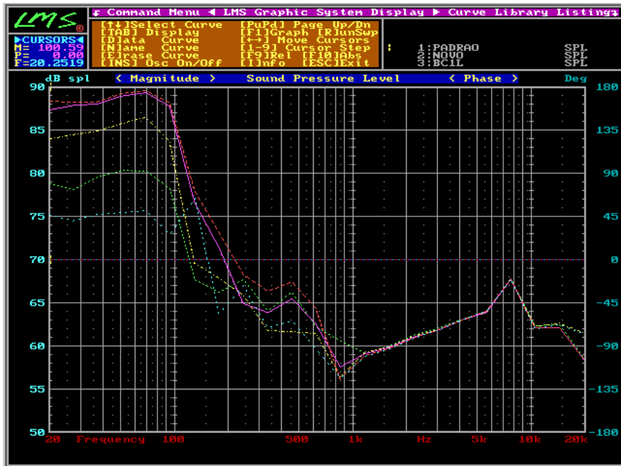
Figura 9 – Curvas com EPIa novo(verde) e EPIas com 2(amarelo), 4(rosa), 6(vermelho) e 8(azul) dias de uso.
