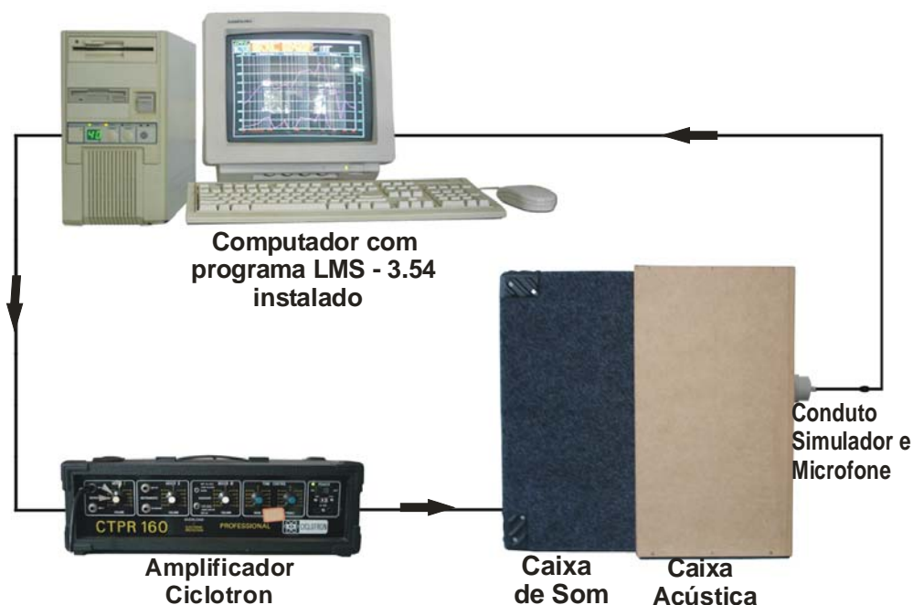
Figura 6 – Envio e recepção de sinal sonoro passando por todo o ciclo do teste.
