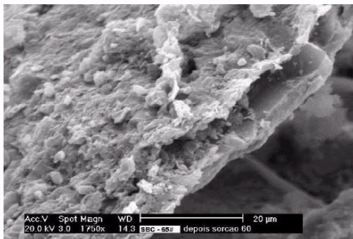
**Figura 4:** MEV do caulim após adsorção com cromo.
